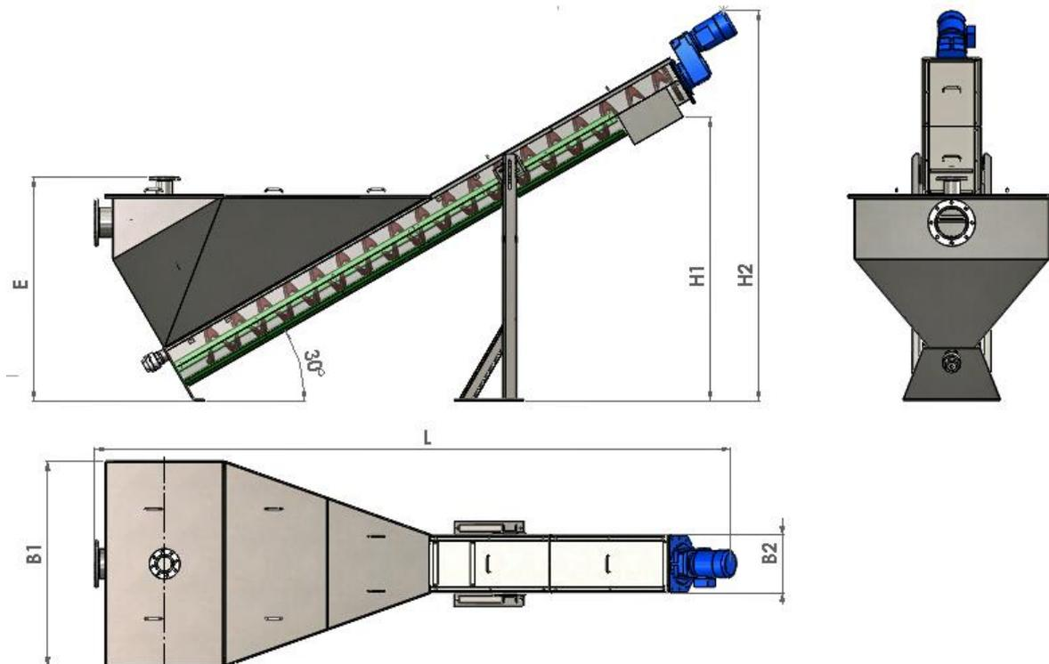
Standardwerkstoffe für Trog und Stützen sind Edelstahl 1.4301 oder 1.4571 glasperlengestrahlt, die Spirale besteht aus Stahl S355J2+N, Verschleißschienen aus Hardox 400.
